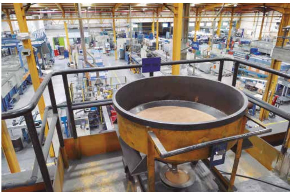
Sinterizazio prozesuaren bidez, burdin, brontze edo altzairu hautsarekin automoziorako pieza metalikoak egiten dituzte Stadler-en
